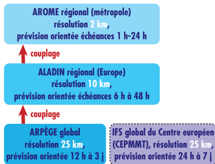
Figure 1 - Principaux systèmes opérationnels de prévision numérique (modèles et assimilations de données) qui seront utilisés à Météo-France à partir de 2008.
